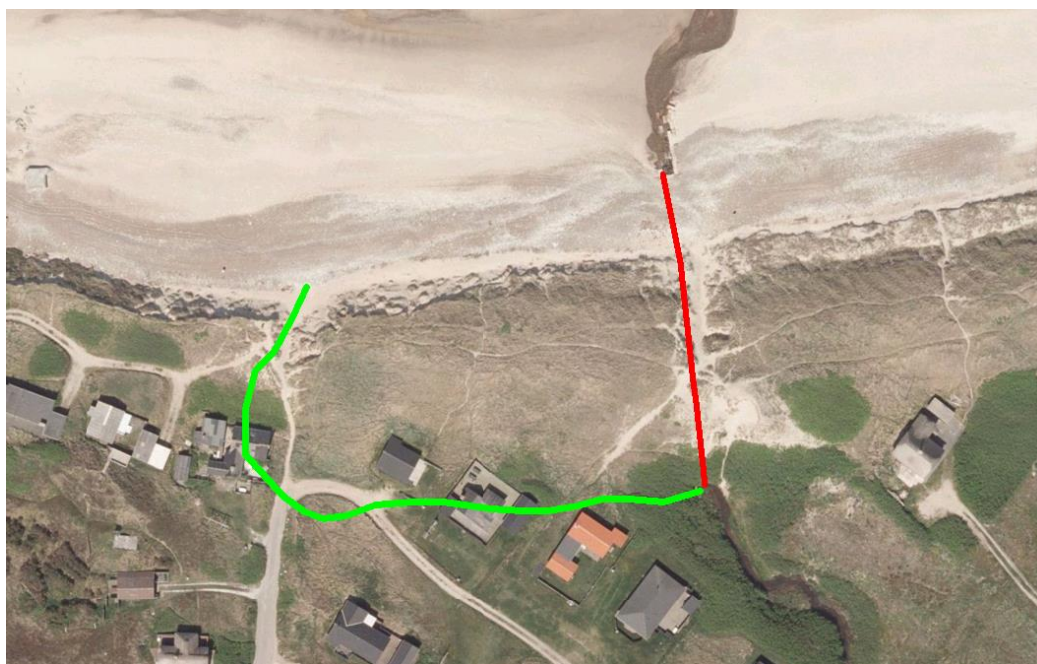
Figur 5.1: Grøn streg viser laveste terræn, som forventes at være Klitmøller Å's oprindelige forløb. Den røde streg er den nuværende rørlægningens placering.
